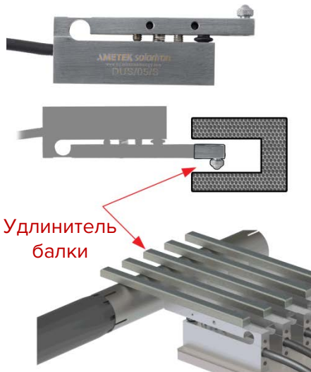
Контроль конического участка несколькими однобалочными зондами
